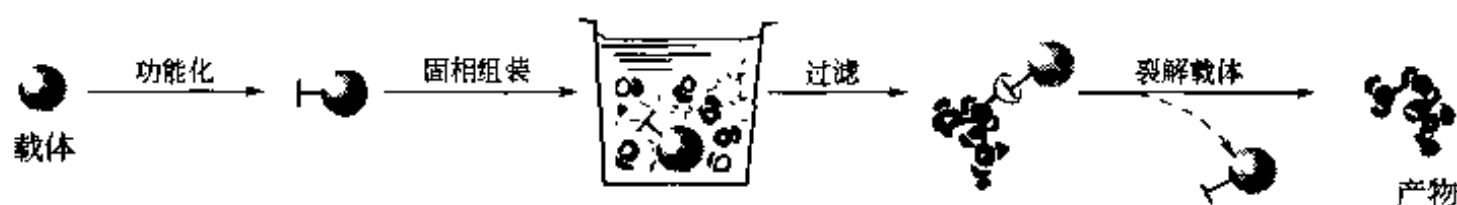
图 1.2 固相有机合成基本原理
